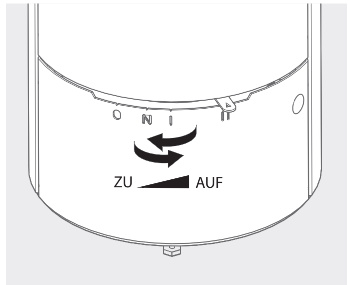
Abb. II Einstellen der Verbrennungsluft
